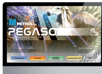
Pegaso é o CNC de última geração para as linhas FICEP, onde o PC, CNC e PLC são todos integrados em uma única placa de circuito para máxima confiabilidade. Pegaso é baseado em uma tecnologia de bus de campo que utiliza CanBus e EtherCAT para controlar até 32 eixos CNC separados.
