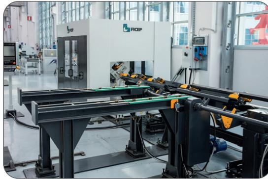
Transferência transversal de alimentação e sistema de carregamento rotativo
