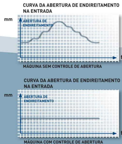
Endireitadoras da série FlatMaster® possuem o controle de abertura servo-hidráulico.
