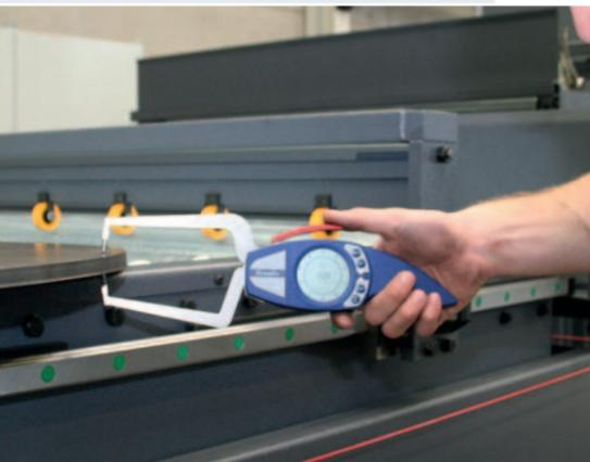
▲ Opcional: Alicete de medição. Ferramenta inteligente para a medição automática da espessura do material.
