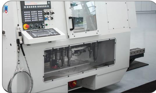
Trocador automático de ferramentas com até 24 ferramentas por cabeçote de perfuração (dependendo do modelo)
