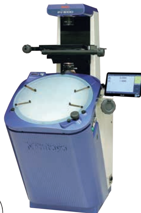
PV-5110 con sistema opcional de procesamiento de datos M2
