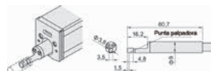
Cabezal sensor para orificios a pa tir de 4 mm de Ø 570531 0051
