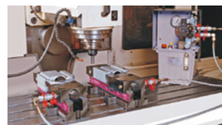
Tipo NCH, de accionamiento hidráulico, disponible por encargo
