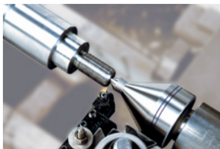
La punta giratoria alargada garantiza el ángulo libre necesario para torneear piezas con diámetros pequeños.
