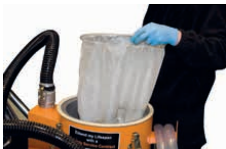
Fácil vaciado del inserto del filtro
