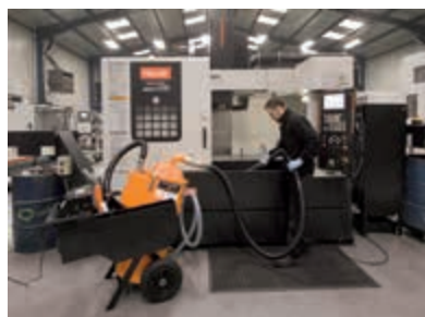
Absorción de la emulsión sucia, virutas y lodos del pulido
