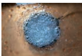
Ventilación del lubricante
