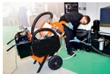
Retroalimentación de la emulsión limpia en el recipiente de lubricante refrigerante
