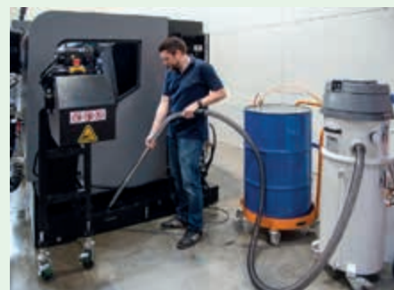
Aspiración de emulsión en procedimiento Bypass directamente en el recipiente de eliminación
