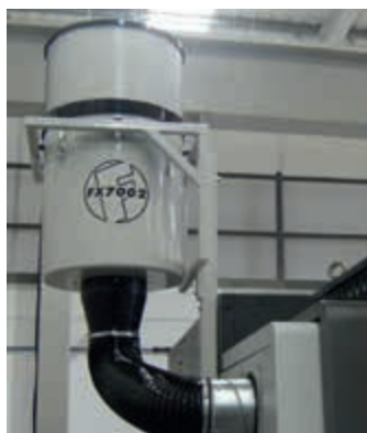
Montaje sobre soporte y aspiración lateral
