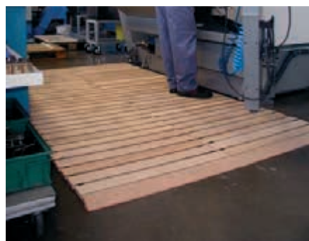
Revestimiento de corindón para una seguridad antideslizamiento máxima disponible por encargo
