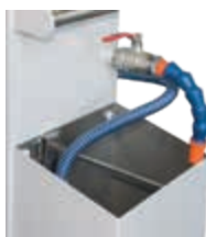
Evacuación de aceites externos en el contenedor con desconexión de nivel (protección de desbordamiento)
