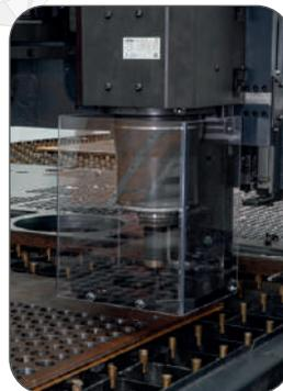
Unidade de Perfuração com Trocador Automático de Ferramentas de 6 posições
