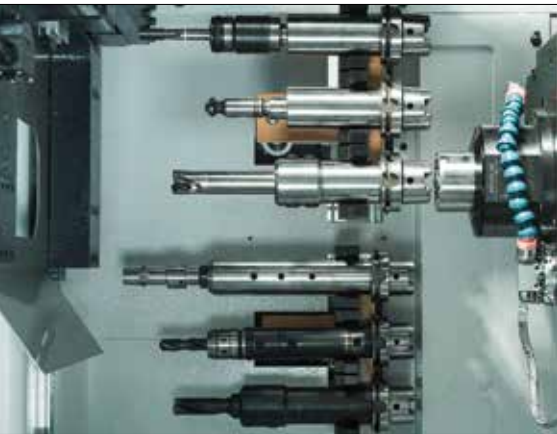
Troca automática de ferramentas com 6 posições
