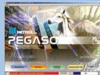
Pegaso é a nova geração CNC das máquinas Ficep. PC, CNC e PLC são todos integrados em uma única placa, para ter a máxima confiabilidade. Pegaso é baseado na tecnologia de bus de campo: CanBus e EtherCAT, com até 32 eixos controlados.
